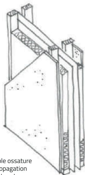
Exemple de double ossature pour limiter la propagation des bruits entre deux locaux.
