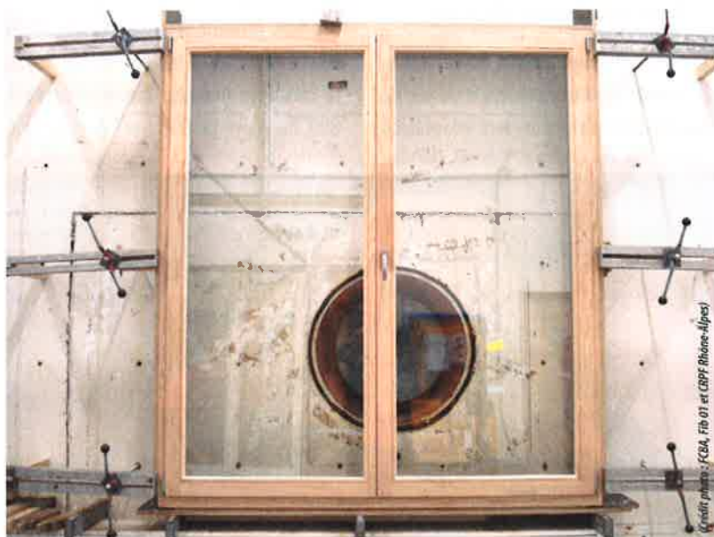
Essais AEVM sur porte-fenêtre en chêne rouge.
