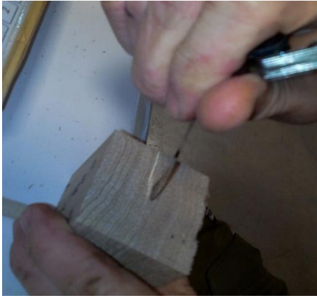
Photo 7 : Mesure de la délamination après cycle d'immersion séchage
